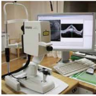
網膜断層検査に用いる光干渉断層計（OCT）。
